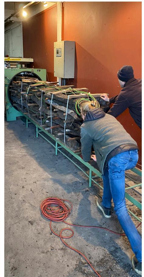
Eichen- und Erlenstämmen werden sauber auf einem Schiebeschlitten gestapelt, bevor sie in die röhrenförmige Trockenkammer eingefahren werden. Foto: © AMH
