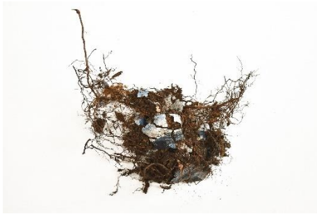
Bild 5: Fragment-Reste im Wurzelwerk von Fragment 8/1 vergraben in Deutschland (Buchholz in der Nordheide) vom 6.11.2017 bis 9.11.2022. Copyright: Matthias Oppermann.
